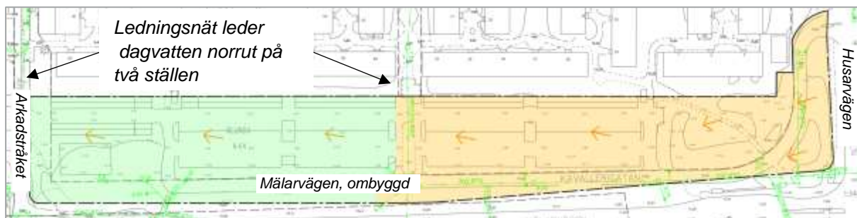
Figur 7. Delavrinningsområden inom planområdet. Ledningsnätet avleder dagvatten norrut vid två punkter. Orange pilar visar markavrinning. Östra delavrinningsområdet är skrafferat med orange och västra med grönt.
