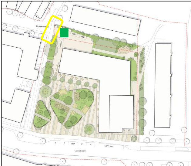
Figur 6. Skiss över avfallslösning 2. Gul rektangel representerar ungefärlig placering av angöringsplats och grön kvadrat representerar möjlig placering av ett fristående avfallsutrymme inom 10 meter från angöringsplats. Källa: Topia landskapsarkitekter, 2024-11-12, bearbetad av WSP.
