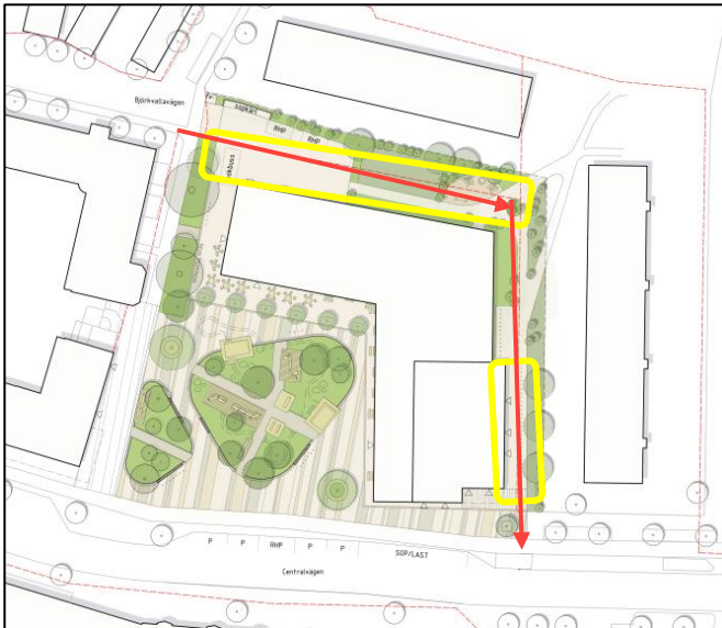
Figur 5. Skiss över avfallslösning 1. Gula rektanglar representerar ungefärlig placering av angöringsplatser. Angöringsplatserna är inte skalenliga utan visar bara en översikt på var angöringen lämpar sig. Röda pilar motsvara vägdragning och körriktning. Källa: Topia landskapsarkitekter, 2024-11-12, bearbetad av WSP.
