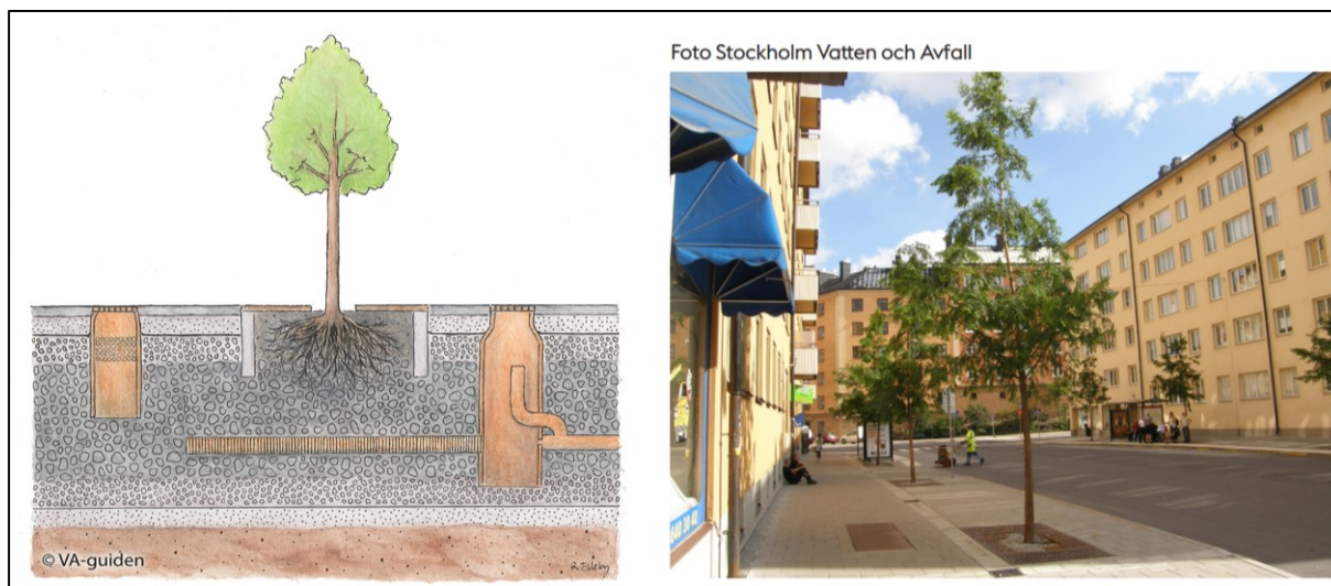
Figur 24. Till vänster: principskiss över skelettjord. Bildkälla: VA-guiden. Till höger: Exempelbild på skelettjord i gatumiljö. Bildkälla: SVOA.
